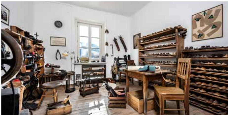
sich in der Werkstatt ein Dreifuß, ein Schusterschemmel und eine Schusterschürze aus Leder, zahlreiche Messer, Zangen und Ahlen, Schusterzwirn, Stoßplatten, T- und Mauskopfnägel und Absatzseisen. Auch schon eine Oberteilmaschine zum Schaftnähen, eine Steppmaschine mit dem Heftzwirn und eine Aufputzmaschine.
